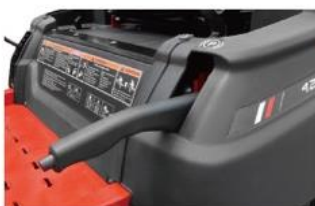
Handrem voor makkelijke bediening met één hand
