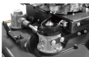
Cardan aandrijving zorgt voor duurzaamheid
