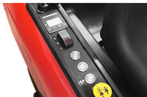
Bedieningspaneel (messenstop, achteruitmaaien, LED, cruise control)
