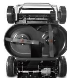
Verschillende draairichting zorgt voor centrale opvang
